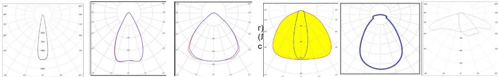
Угол рассеяния прожекторов составляет  $30^\circ < 2\gamma \leq 80^\circ$
