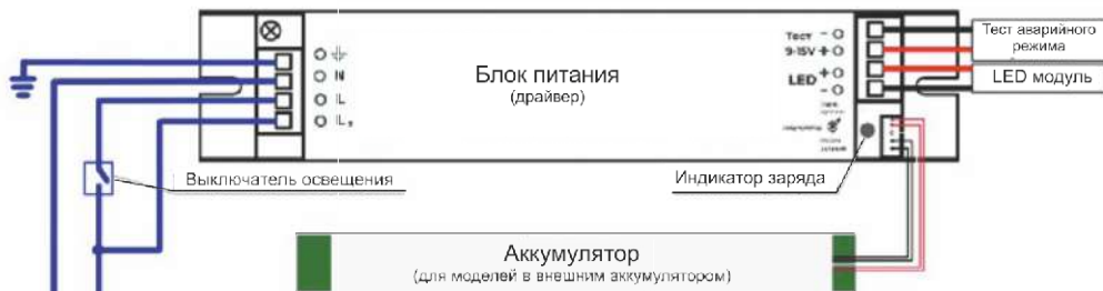
Схема подсоединения сетевых проводов в клеммные разъемы БАГ
