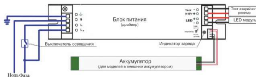
Схема подсоединения сетевых проводов в клеммные разъемы БАП
